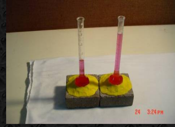
Rilem Tüpleri ile geçirimsizlik Testi
